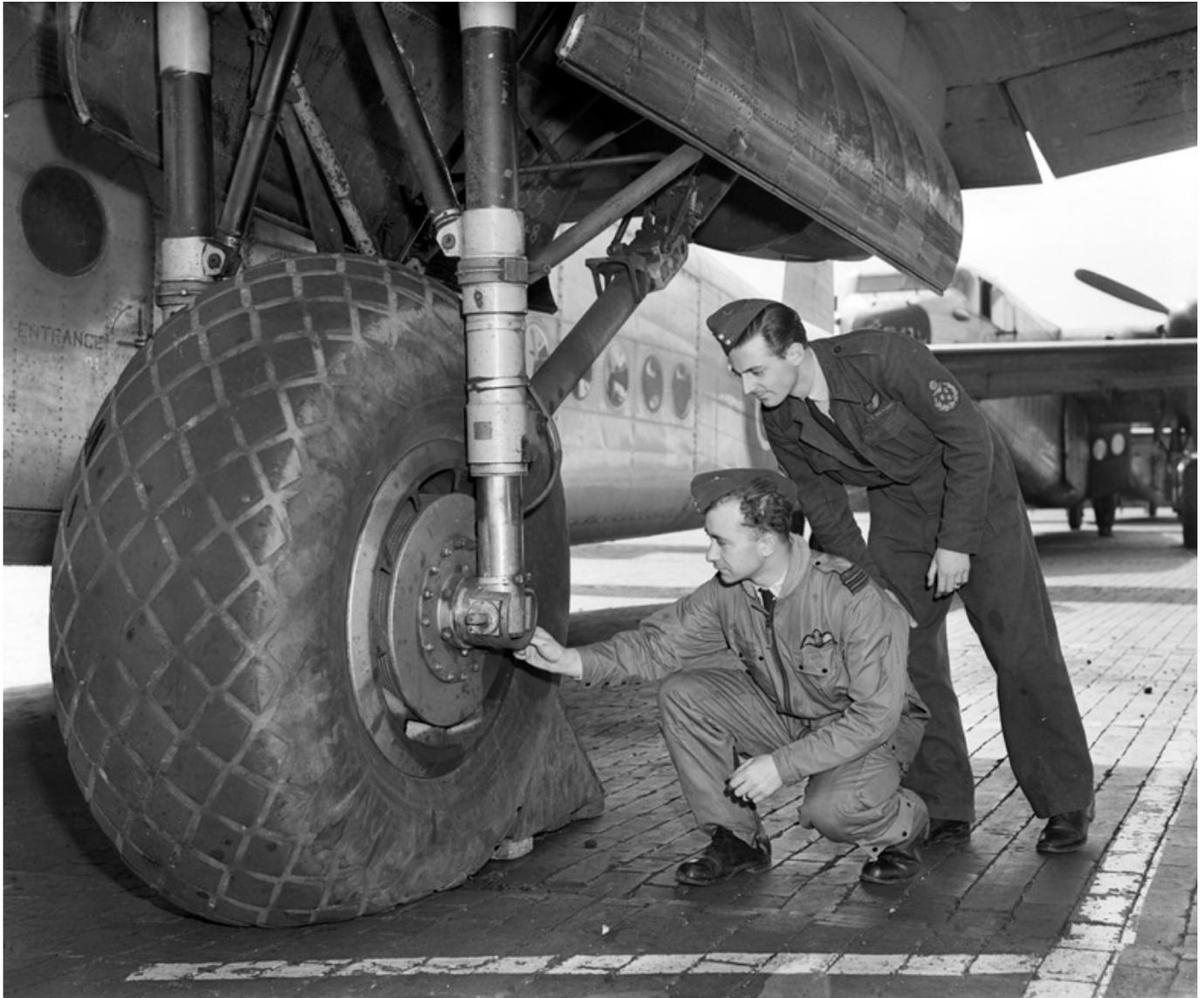
Fahrwerkskontrolle an einer Avro York in Gatow, 1948/49. Kleinere Reparaturen konnten in Gatow ausgeführt werden. Die größeren Arbeiten und regelmäßigen Inspektionen fanden auf den Luftwaffenstützpunkten in Großbritannien statt. Crown copyright 1948, reproduced under the terms of the Open Government Licence, published as a courtesy of Air Historical Branch, RAF (GAT R-1844)
